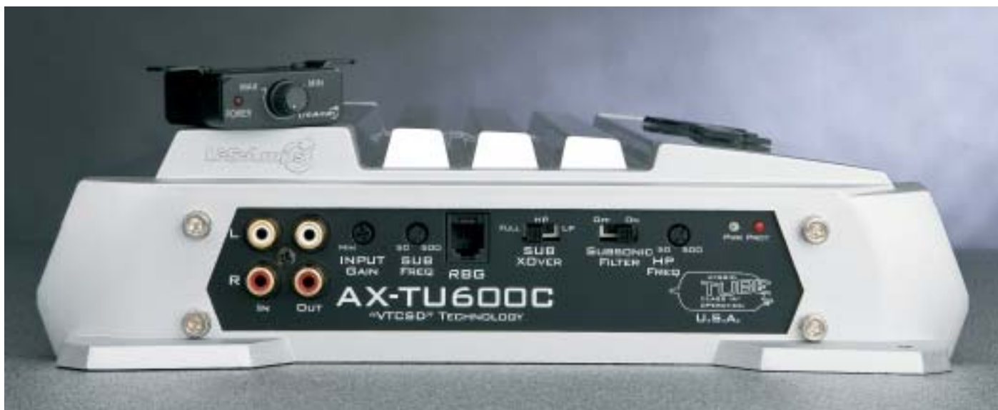
Anche i connettori di segnale , con prese d'ingresso e uscita stereo RCA, hanno i contatti dorati. La sezione controlli permette la regolazione indipendente dei filtri passa basso (LP) e passa alto (HP) nella gamma da 50 a 500 Hz.
